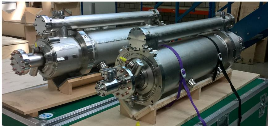
**Abb. 4.1.** – Foto zweier MESA Kavitäten im Heliumtank. Die Röhren oben auf den Tanks dienen dem Abführen des gasförmigen Heliums, ohne die Zufuhr von flüssigem Helium zu stören. Je zwei Tanks werden in einem Kryomodul installiert, zu sehen in Abb. 1.2. Aufgenommen von T. Stengler im Mai 2017 beim Hersteller der Kryomodule, *RI Research Instruments GmbH*.
