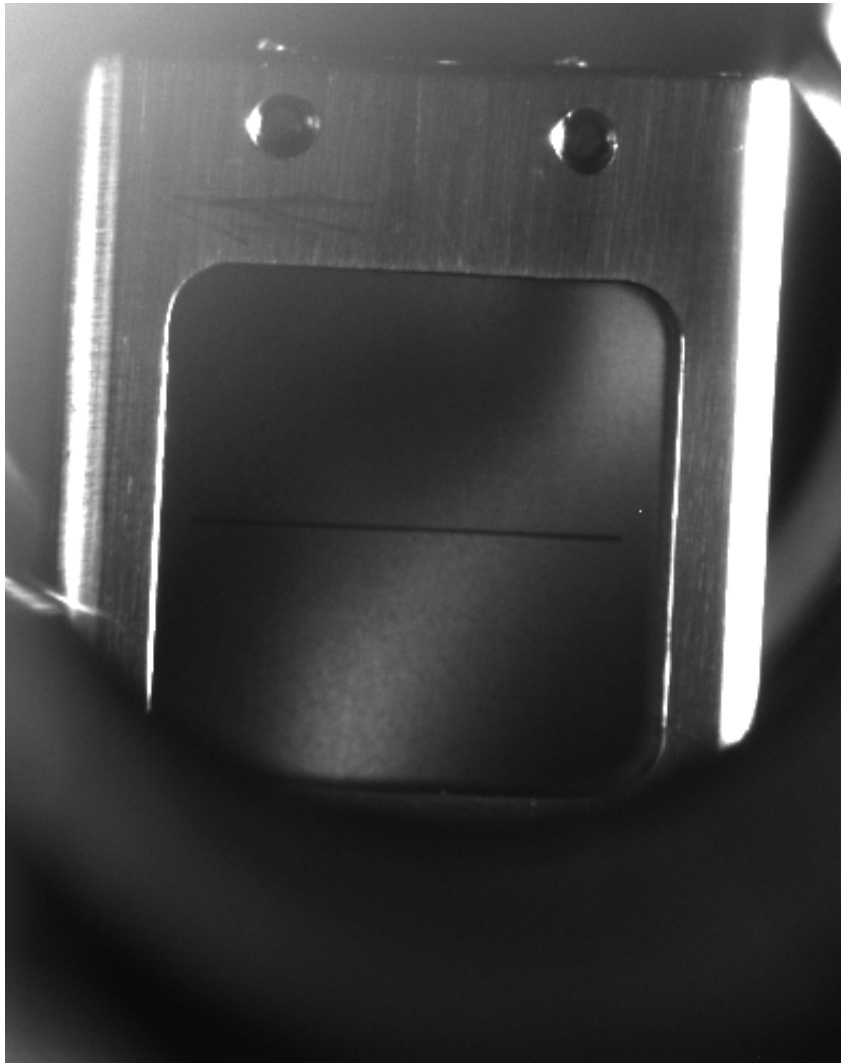
Abbildung A.3.: Bild des Analysierspalts. Die beiden Kanten des 100 \mu\text{m} breiten Spalts lassen sich noch voneinander unterscheiden, sodass die Bildfehler des Objektivs mit 100 \mu\text{m} abgeschätzt werden können.
