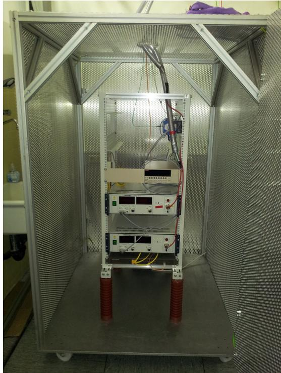
Abb. A.18.: Foto des geerdeten Hochspannungsracks für die Wien-Filter-Netzteile und das Picoamperemeter. Die Stützisolatoren haben eine Höhe von 300 mm genauso wie der Abstand zwischen allen Wänden und dem Rack. Die Fernbedienung erfolgt faseroptisch. Der Schirm der Hochspannungskabel liegt wie das Rack ebenfalls auf 26 kV und wurde deshalb mit zwei Schläuchen als Isolierung zum Experiment geführt.
