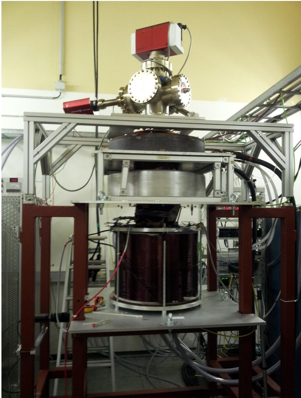
Abb. 4.3.: Foto des modifizierten Teststandes mit Wien-Filter und einem Leuchtschirm nach dem Einlassen der Strahlkammer in den Magnetführungsaufbau. Eine Nivellierung der Kammer konnte nicht mehr durchgeführt werden, sodass ein endlicher Winkel zwischen Kathodenoberflächennormale und dem longitudinalen Magnetfeld dafür sorgt, dass der Strahl später nicht zentriert auf den Schirm fällt. Dies ist für die weitere Diskussion aber unerheblich.
